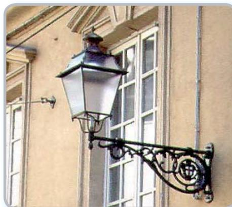
Mensole artistiche con piastra di fissaggio a muro, anelli di raccordo con l'asse orizzontale e decorazione ottenuti dalla fusione in unico getto di alluminio. L'asse orizzontale in acciaio, termina con il sostegno lanterna, realizzato in tornitura di ferro per attacco 3/4" gas. La finitura avviene con sabbiatura, sbavatura e verniciatura nel colore nero antracite.
