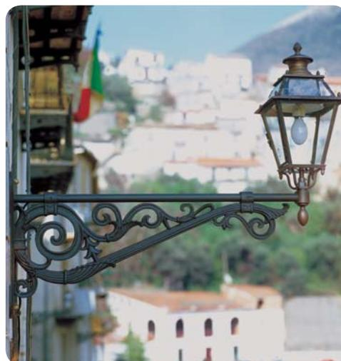
Mensole artistiche con piastra di fissaggio a muro, anelli di raccordo con l'asse orizzontale e decorazione ottenuti dalla fusione in unico getto di alluminio. L'asse orizzontale in acciaio, termina con il sostegno lanterna, realizzato in tornitura di ferro per attacco 3/4" gas. La finitura avviene con sabbiatura, sbavatura e verniciatura nel colore nero antracite.
