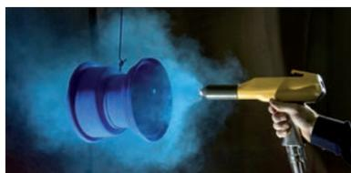
I componenti in lamiera d'acciaio vengono verniciati a polveri epossidiche termoindurenti con cottura a forno per una finitura resistente e duratura.
