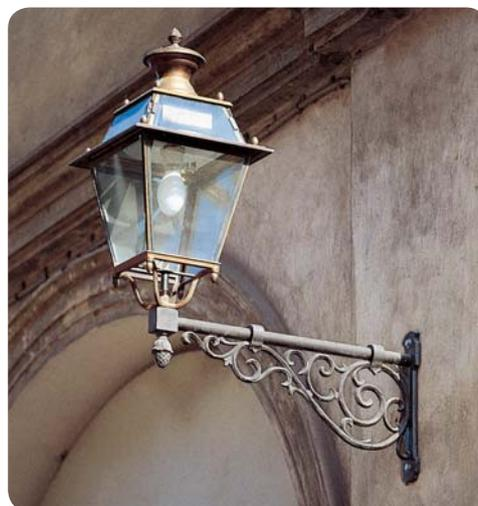
Mensole artistiche con piastra di fissaggio a muro, anelli di raccordo con l'asse orizzontale e decorazione ottenuti dalla fusione in unico getto di alluminio. L'asse orizzontale in acciaio, termina con il sostegno lanterna, realizzato in tornitura di ferro per attacco 3/4" gas. La finitura avviene con sabbatura, sbavatura e verniciatura nel colore nero antracite.
