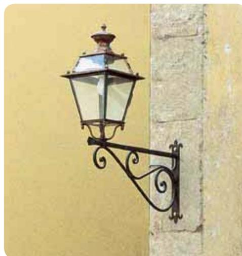
Mensole artistiche in ferro, con trama decorativa composta da riccioli in ferro battuto accostati da fregi e legature sagomate. dispone di piastra per attacco a parete, saldata con procedimento a filo continuo a regola d'arte. Il passaggio dei cavi elettrici avviene all'interno dell'asse orizzontale in tubo con attacco per il corpo illuminante realizzato in ferro tornito e filettato  $\frac{3}{4}$ " gas. Finitura con zincatura e verniciatura a polveri epossidiche bicomponenti.
