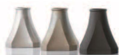
Le basi vengono sbavate, sabbiate e lavorate a regola d'arte. Segue trattamento di passivazione in bagno di Alodine 1200 prima della verniciatura a polveri termoindurenti.
