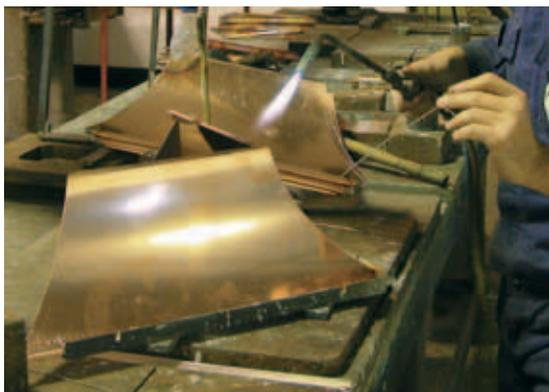
**LASTRA di RAME** - Brasatura forte per rame e rame/ottone, eseguita al cannello, con lega a base di argento e rame, con temperatura di fusione superiori ai 450 °C
