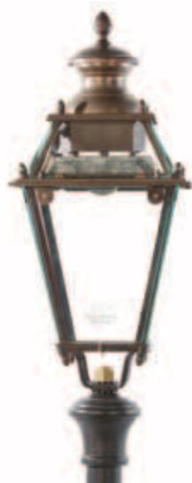
Gli schermi realizzati in vetro di spessore 5 mm, trasparente o su richiesta opale stampato C, sono temperati termicamente in corrispondenza alle norme EN 12150. Resistenti allo sbalzo termico e all'urto meccanico, sono prescritti alla Norma EN 60598-2-3 comma 3.6.5, ed in caso di rottura si sbriciolano in minuscoli frammenti inoffensivi.
