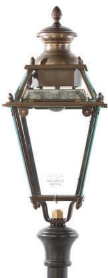
Gli schermi realizzati in vetro di spessore 5 mm, trasparente o su richiesta opale stampato C, sono temperati termicamente in corrispondenza alle norma EN 12150. Resistenti allo sbalzo termico e all'urto meccanico, sono prescritti alla Norma EN 60598-2-3 comma 3.6.5, ed in caso di rottura si sbriciolano in minuscoli frammenti inoffensivi.
