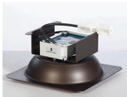
Per semplificare ulteriormente la procedura di sostituzione della sorgente luminosa su apparecchi preesistenti, è stato sviluppato il sistema di fissaggio della piastra in lamiera mediante l'impiego di ganci a scatto che permettono l'inserimento tra il telaio superiore ed il cappello od i vetri, riducendo il tempo ed i passaggi di intervento ad un unico aggancio immediato.
