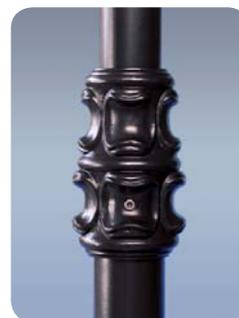
Per il collegamento alla linea il palo è dotato di una morsettiera di derivazione 500V classe II – IP23 stampata in resina poliammidica autoestinguenta, alloggiata nell'asola d'ispezione, protetta da un portello in pressofusione di alluminio con protezione IP54 con chiusura a chiave. La morsettiera è dotata di sezionatore con fusibile.
